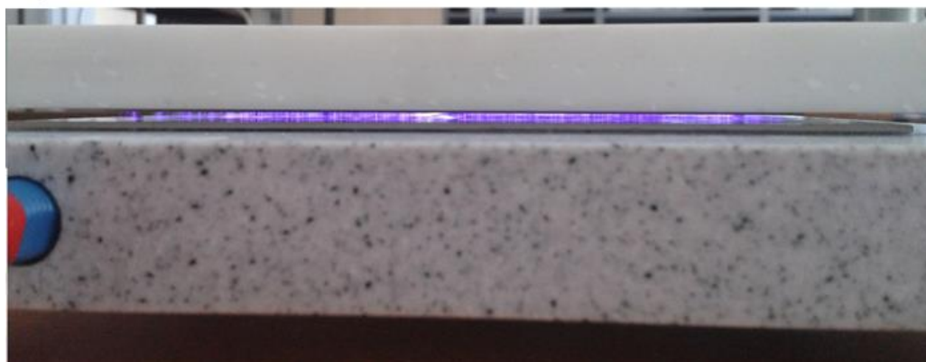
Rys. 2. Zastosowany reaktor DBD (a) oraz widok mikrowyładowań podczas procesu modyfikacji plazmowej (b) (opracowanie własne autora)
